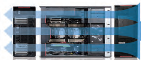
3基のファンで各所へエアの流れを誘導する Tri-Channel™クーリング (写真はThinkStation P920)
