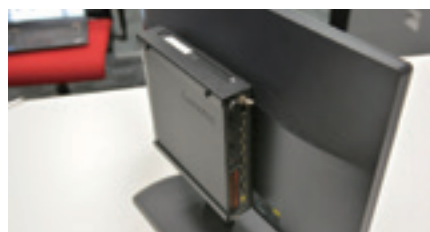
ソリューション③のオプションを利用しモニター背面へ装着したケース。さらに光学ドライブを搭載することも可能。
