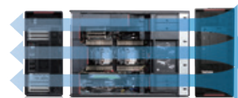
3基のファンで各所へエアの流れを誘導する Tri-Channel™ クーリング（写真は ThinkStation P920）
