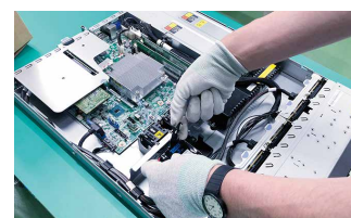
作業時は帯電防止手袋を着用
