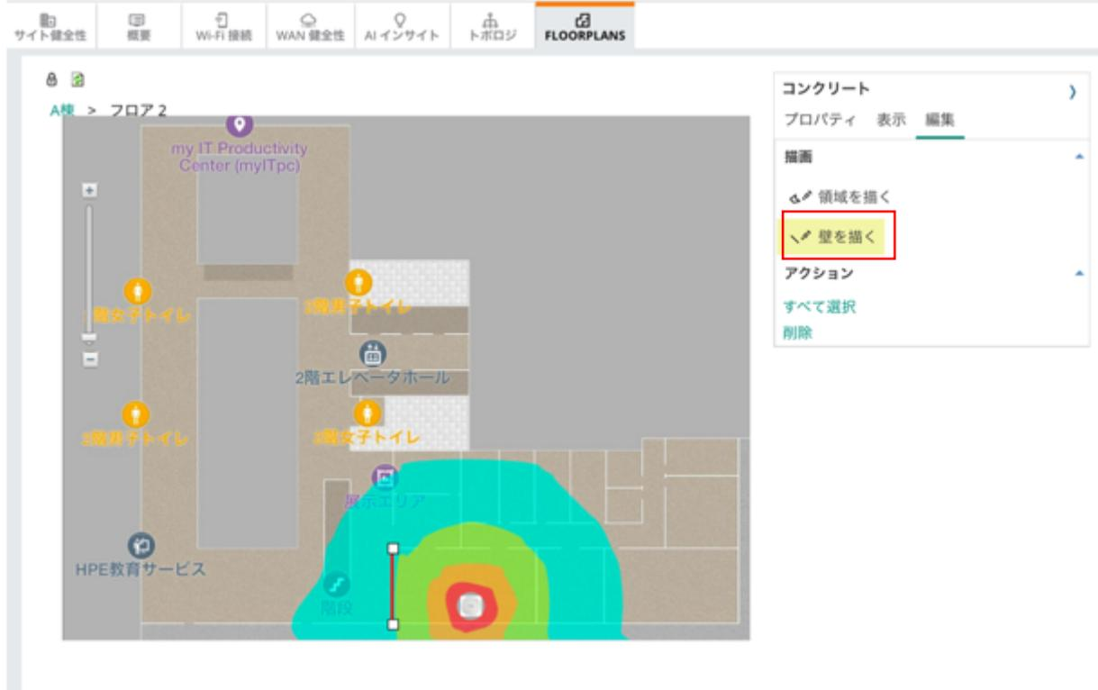
⑦ プロパティから壁の材質を選択可能。壁の材質によって電波の減衰が定められており、リアルタイムにヒートマップが変化する。
