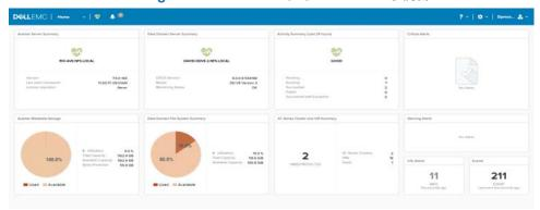
XCシリーズの Data Protection Management Consoleは、XCシリーズ専用の新しい管理フレームワークです。Prism Central 5.5.xを実行しているユーザは、Prism Management Consoleからシングルクリックで起動し、単一のインターフェースから複数のXCシリーズクラスタの共通データ保護機能を監視・管理することができます。
